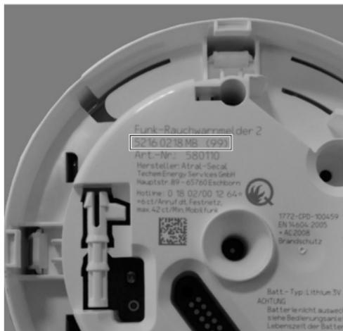
**5** Așezați detectorul rotindu-l ușor în sens antiorar pe placa de montare și rotiți-l apoi fără forță excesivă în sens orar până ce se înclichetează.
