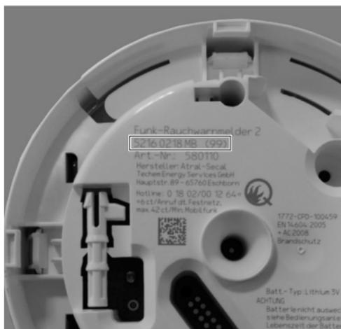
**5** Fastgør enheden til montagepladen med et let drej i urets retning, uden at anvende for meget kraft, indtil den låser fast.
